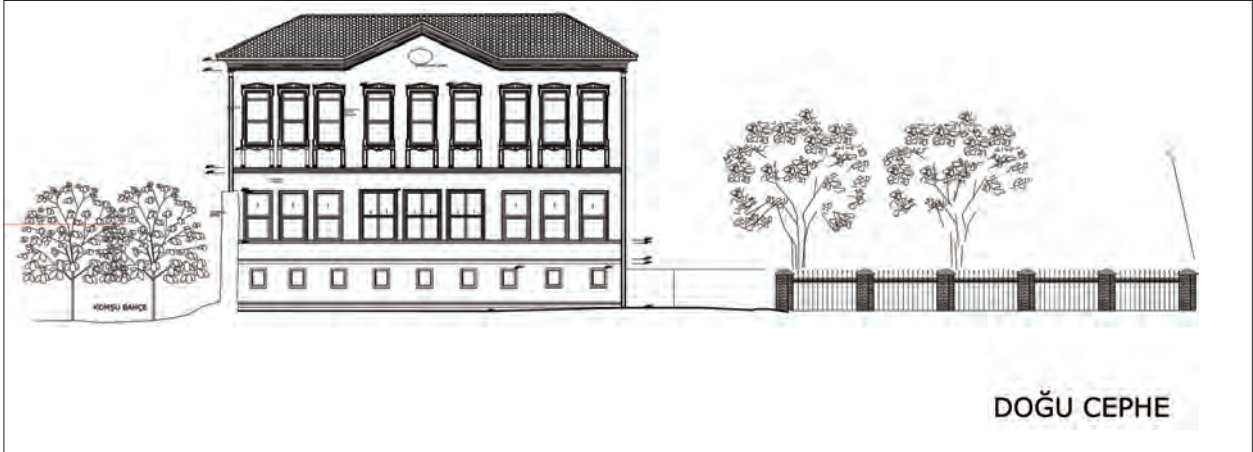
Res. 37. A yapısı doğu cephe rekonstrüksiyon projesi
